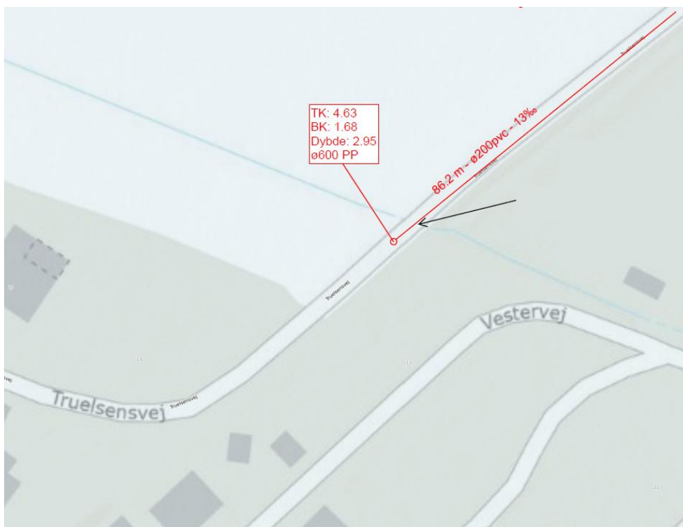
Figur 1: Spildevandsledningen er tegnet med rød. Krydsningen af vandløbet sker ved pilen.
