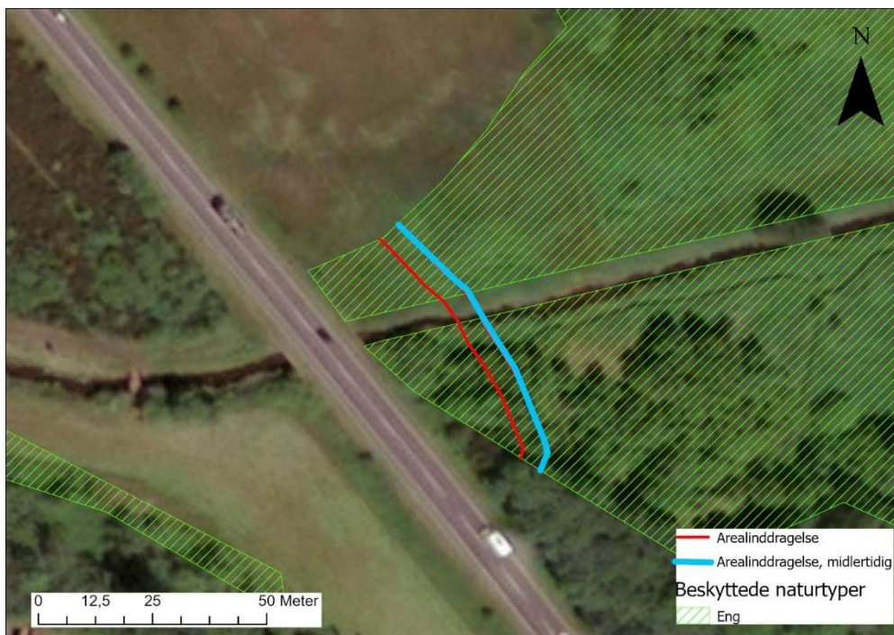
Figur 5 - Beskyttet eng nord og syd for Alslev Å. Den røde linje viser grænsen for permanent inddraget areal. Området mellem den blå linje og den røde linje viser det areal der midlertidigt inddrages i anlægsfasen. Kort udarbejdet af Vejdirektoratet.
