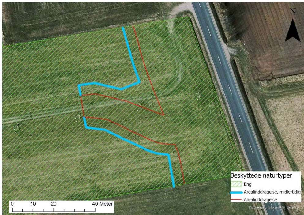
Figur 8 - Beskyttet eng på lufthavnens areal. Den røde linje viser grænsen for permanent inddraget areal. Området mellem den blå linje og den røde linje viser det areal der midlertidigt inddrages i anlægsfasen. Kort udarbejdet af Vejdirektoratet.
