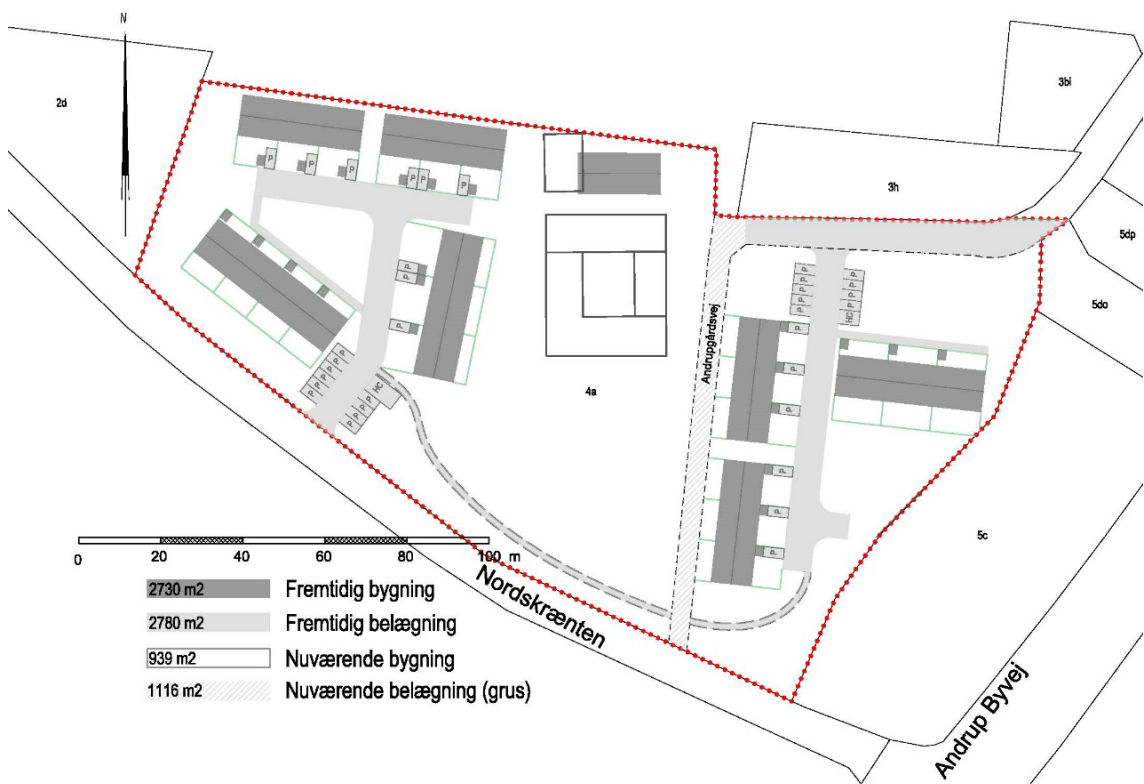
Fig. 6. Befæstelse efter etablering, med udgangspunkt i udstykningsplan, opmålt af LandSyd i/s.
