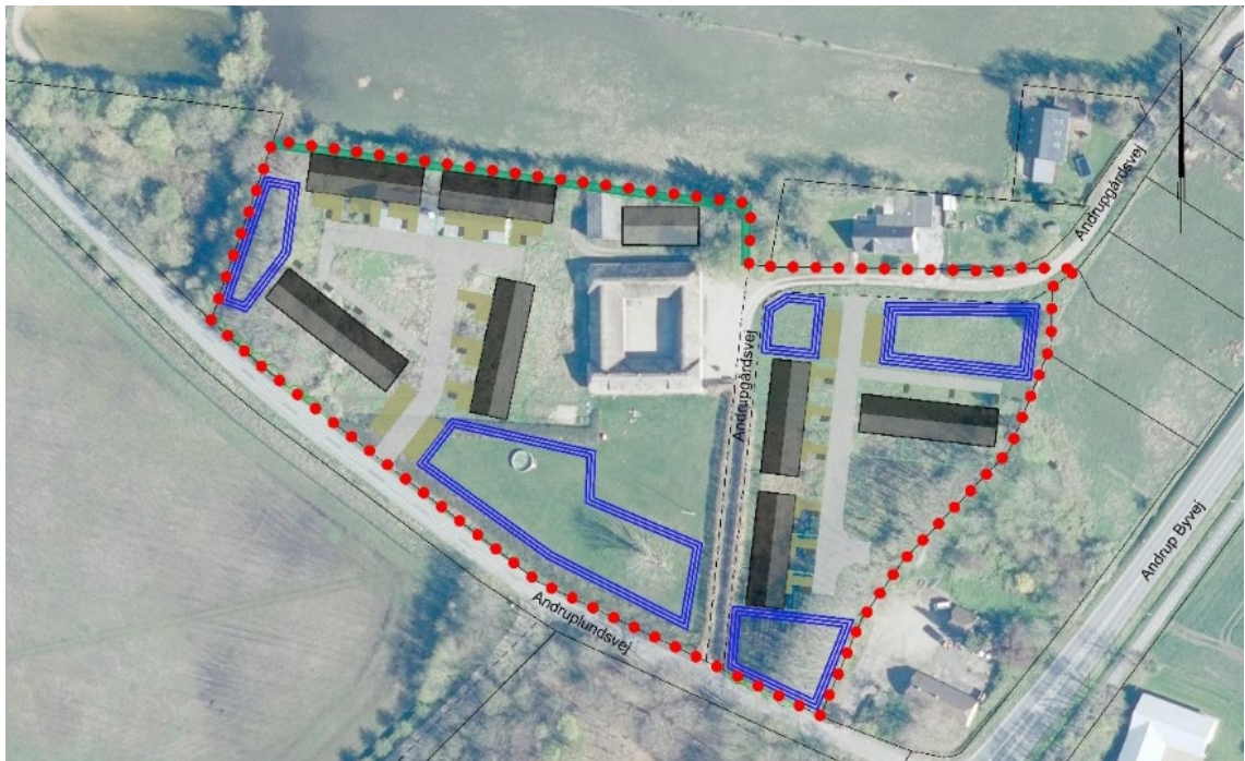
Fig. 8. Arealer til regnbæde er indrammet med blå streg, i alt vises et areal på ca. 3.500 m 2 .
